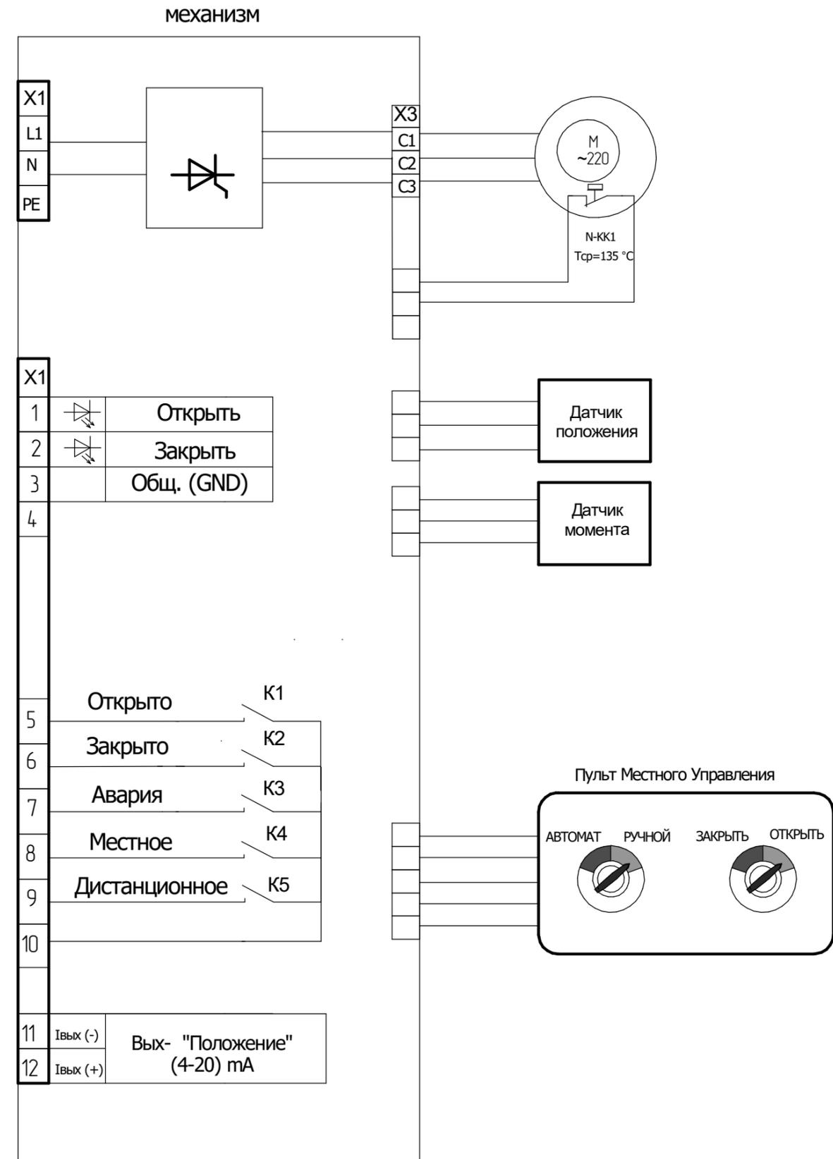
Рисунок В.2 – Схема подключения механизма МЭПК с блоком ЕД 220
