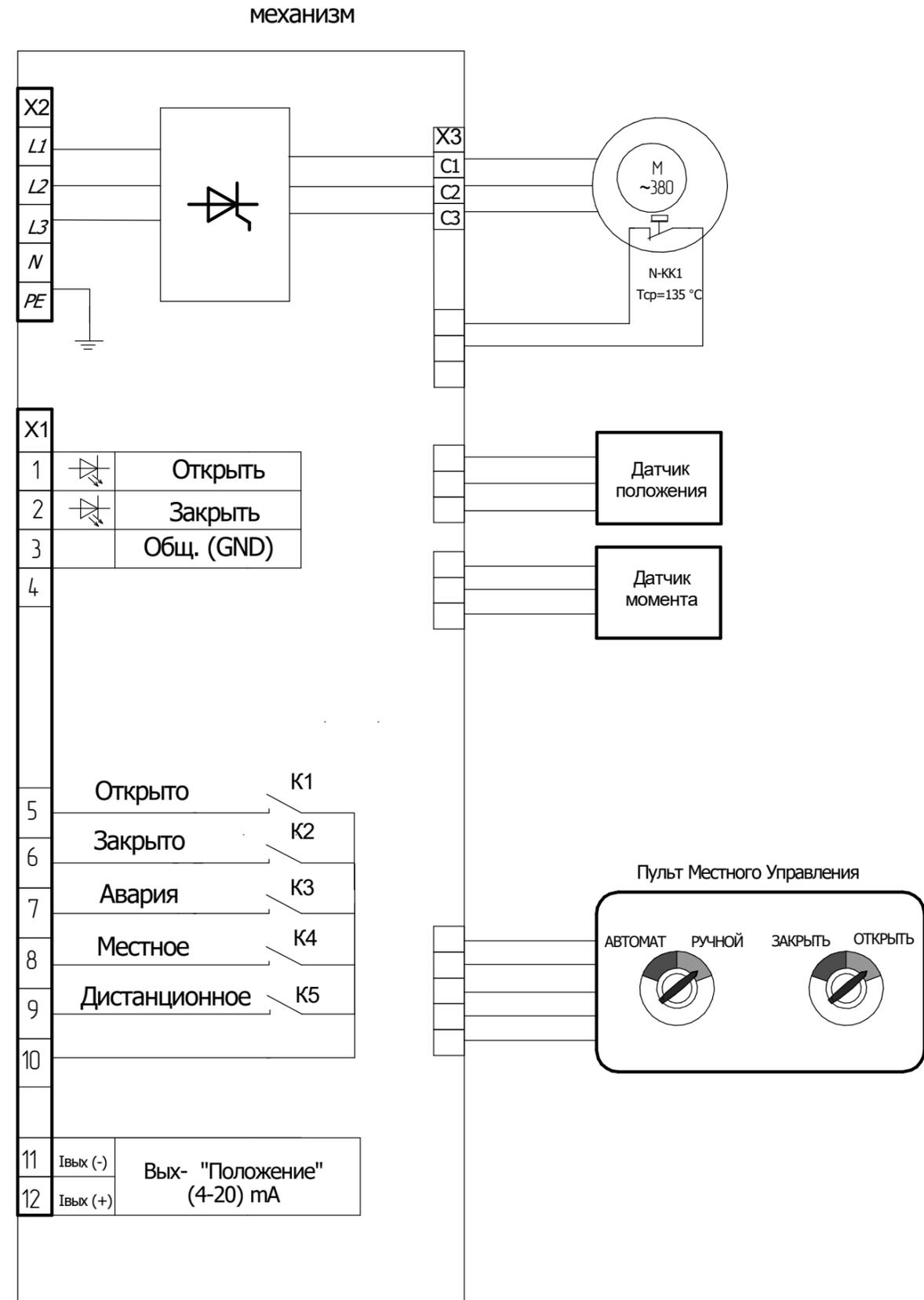
Рисунок В.1 – Схема подключения механизма МЭПК с блоком ЕД-380
