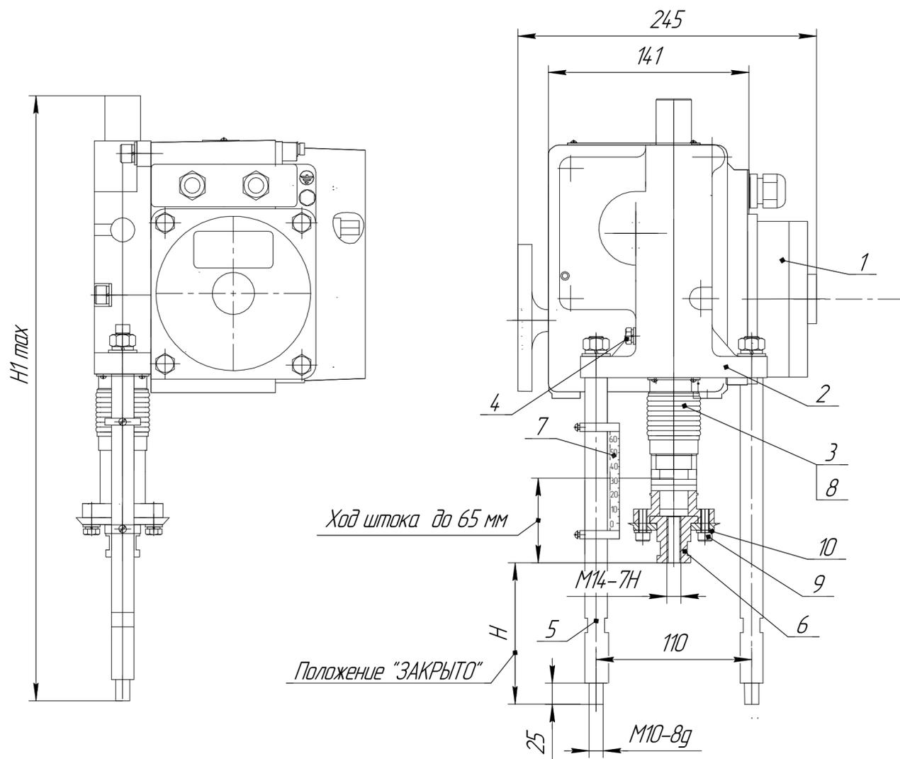
Рисунок А.1 – Механизм МЭПК-6300-20
