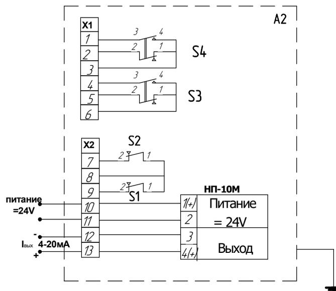
Рисунок Б.2 - Схема механизма с блоком БСПТ-IICT4
